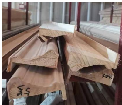
图1 木门套装饰线条PE膜增强柔性薄木饰面
